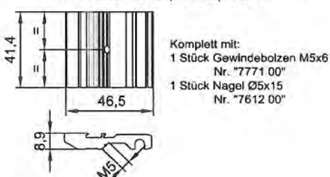
Stoßverbinder-Nr. "9924 00" (Außenkammer) für Profil-Nr. "9834", "9824", "9894"
