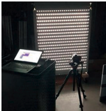
Abbildung 19 + 20: Messaufbau: Ein Rollladenpanzer wird von der Außenseite mit einer vorgegebenen Lichtinstallation mit definierter Leucht- und Lichtdichte gleichmäßig beleuchtet. Auf der Innenseite wird mit einer photometrischen Kamera die Leuchtdichte bzw. Lichtstärke gemessen und am PC ausgewertet. (Quelle: Hella)
