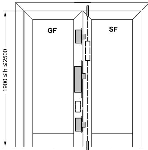
**Variante 4: Gangflügel: 3 Fallenriegelschloss Mehrfachverriegelung
