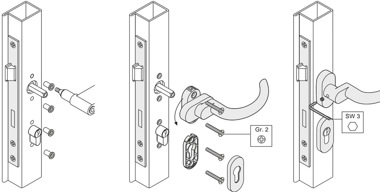
1. Die Einnietmuttern nach einander auf den Gewindedorn eines Nietwerkzeuges aufschrauben.
