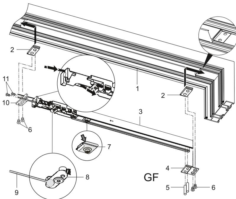
**Gleitschiene am Gangflügel montieren**
