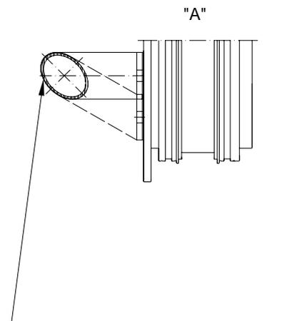
St-Rohr (z.B. 201 020) mit KS-Distanzhülse (z.B. 237 273) ab Bohrungsabstand  $A > 1500$  bzw. stark frequentierten Türen empfohlen
