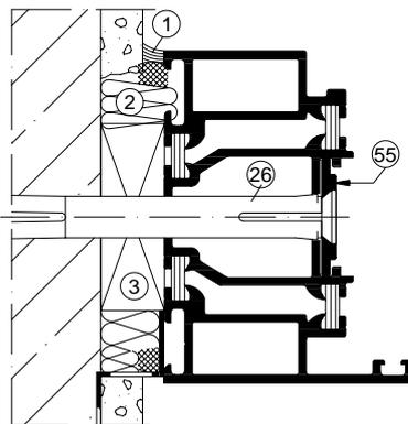
Oberer Wandanschluss bei Deckendurchbiegung
