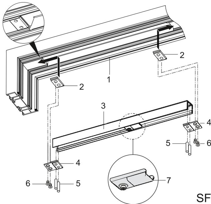
**Gleitschiene am Standflügel montieren**
