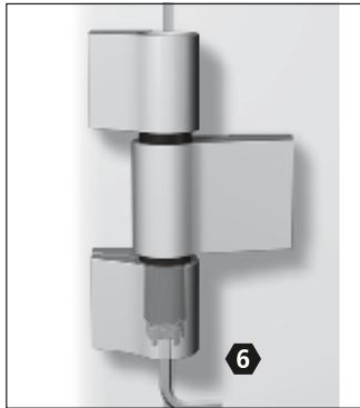
6. Mit Verstellstern untere Lagerbuchse um  $\pm 90^\circ$  drehen bis sie spürbar einrastet.
