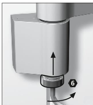
8. Hebespindel montieren
