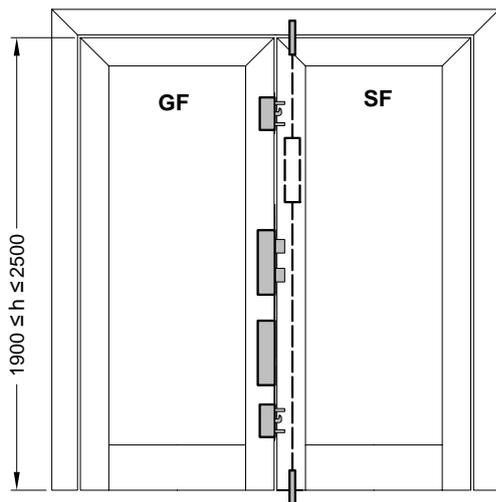
**Variante 3: Gangflügel: 3 Fallenriegelschloss Mehrfachverriegelung
