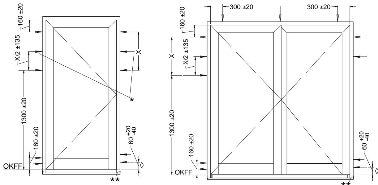
\* Zusätzlich Anker/Dübel bei  $X > 800$
