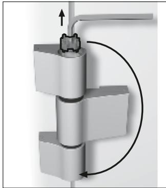
5. Verstellstern entnehmen und in unteres Bandteil einsetzen.
