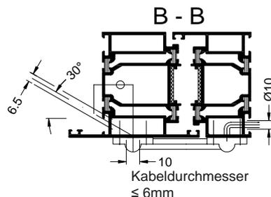
**Einlass-Stößelkontakt, Riegelschaltkontakt und Magnetschalter-Set**
