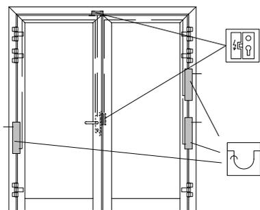
Kabelübergang 229 730 / 238 522 für verdeckte Montage
