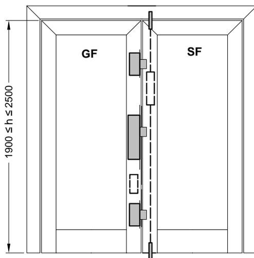
**Variante 2: Gangflügel: 7 Riegel-Fallenschloss - Motorschloss
