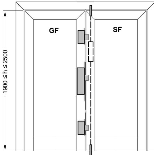
**Variante 5: Gangflügel: 3 Fallenriegelschloss Mehrfachverriegelung
