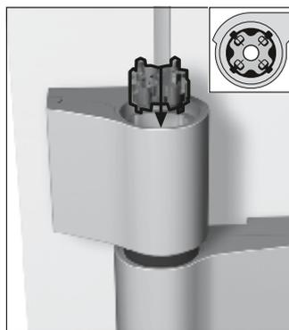
7. Verstellstern im oberen Rahmenbandteil positionieren
