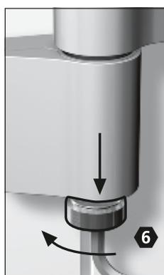
2. Hebespindel heraus-schrauben
